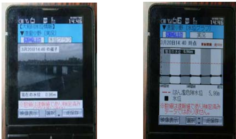
写真8 ワンセグ画面（観測地点の映像・水位観測地点時系列水位変化）
