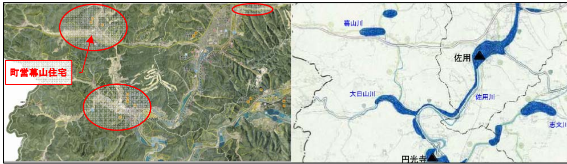
図-5 佐用町防災マップの浸水想定(左)と浸水実績(右:県の公表資料)の対比
