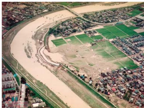
写真.1 五十嵐川左岸の破堤現場（三条市諏訪新田、04.7.18 アジア航測撮影）
