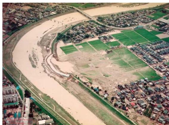
写真1 五十嵐川左岸の破堤現場 (三条市諏訪新田、2004.7.18 アジア航測撮影)
