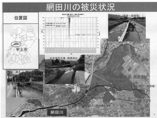
図-4 公共土木被害の報告様式(代表地点被害報告) (熊本県提供資料より)
