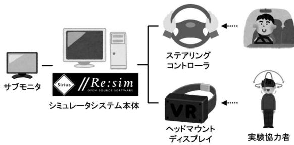
図-2 シミュレータシステムの概略
